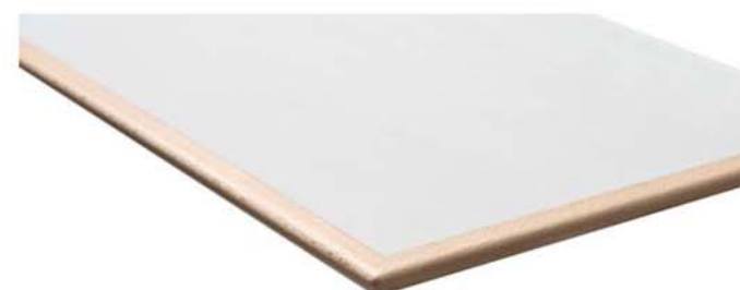
Type de bord E Panneau MDF avec Linoléum ou résine synthétique revêtu ou plaqué, bord solide 10mm en contre-dépouille tout autour et en coupe d'onglet
